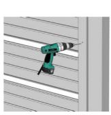
Nach dem Zusammenstecken der Füllung bohren Sie mit einem Bohrer (d=6mm)die Füllung an den vorgegebenen Löchern des Rahmenprofils aus und befestigen Sie diese anschließend mit den Kunststoffschrauben.
